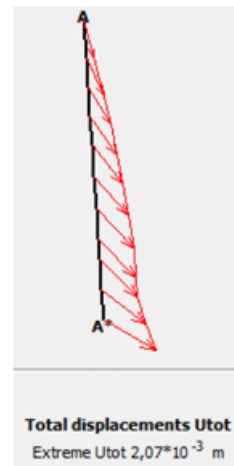
Gambar 11. Deformasi Pile Kombinasi 2
